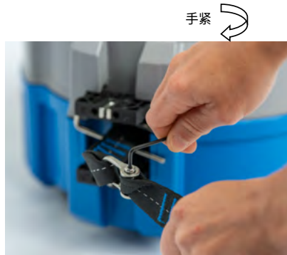
正确安装卸扣
